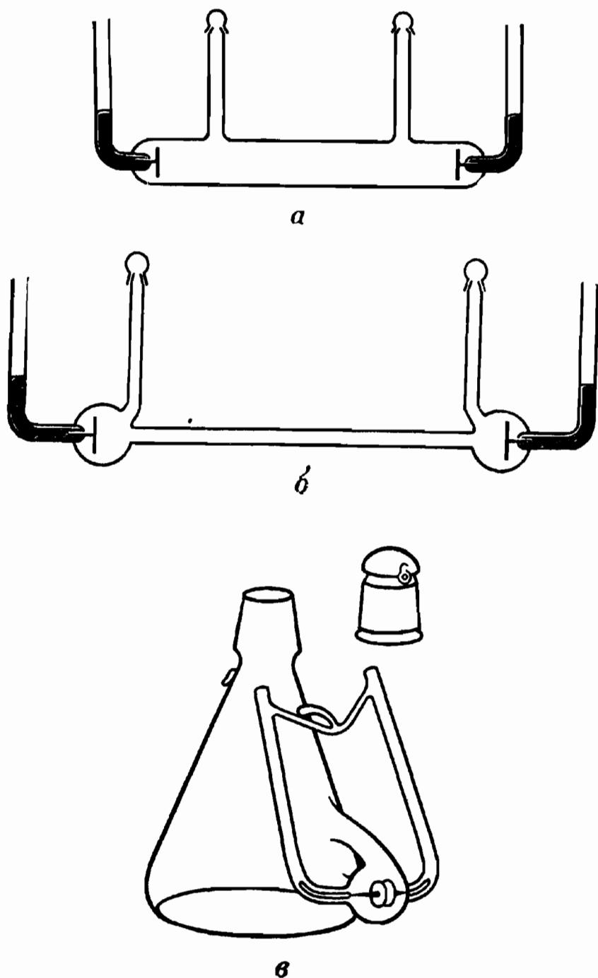
Рис. 5.3. Типичные конструкции ячеек для измерения электропроводности растворов средней (а), высокой (б) и низкой (в) концентрации. Тип б предложен в работе Дэггета, Бэра и Крауса [44].
