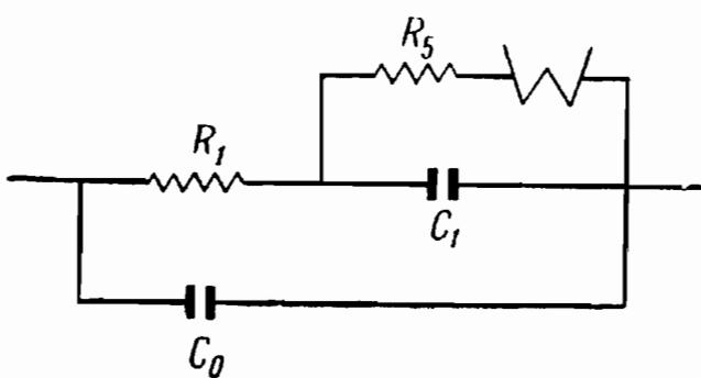
Рис. 5.4. Электрическая схема, эквивалентная ячейке для измерения электропроводности.
