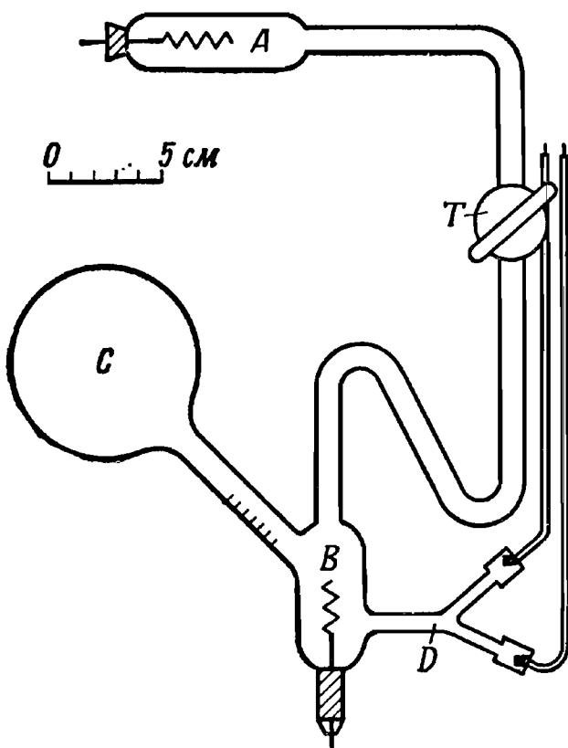
Рис. 5.7. Схема прибора для определения чисел переноса, по Стилу и Стоксу [20].
