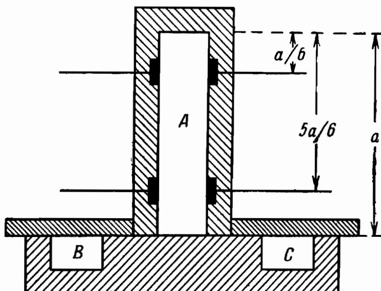
Рис. 10.4. Схематическое изображение кондуктометрической диффузионной ячейки Харнеда.
