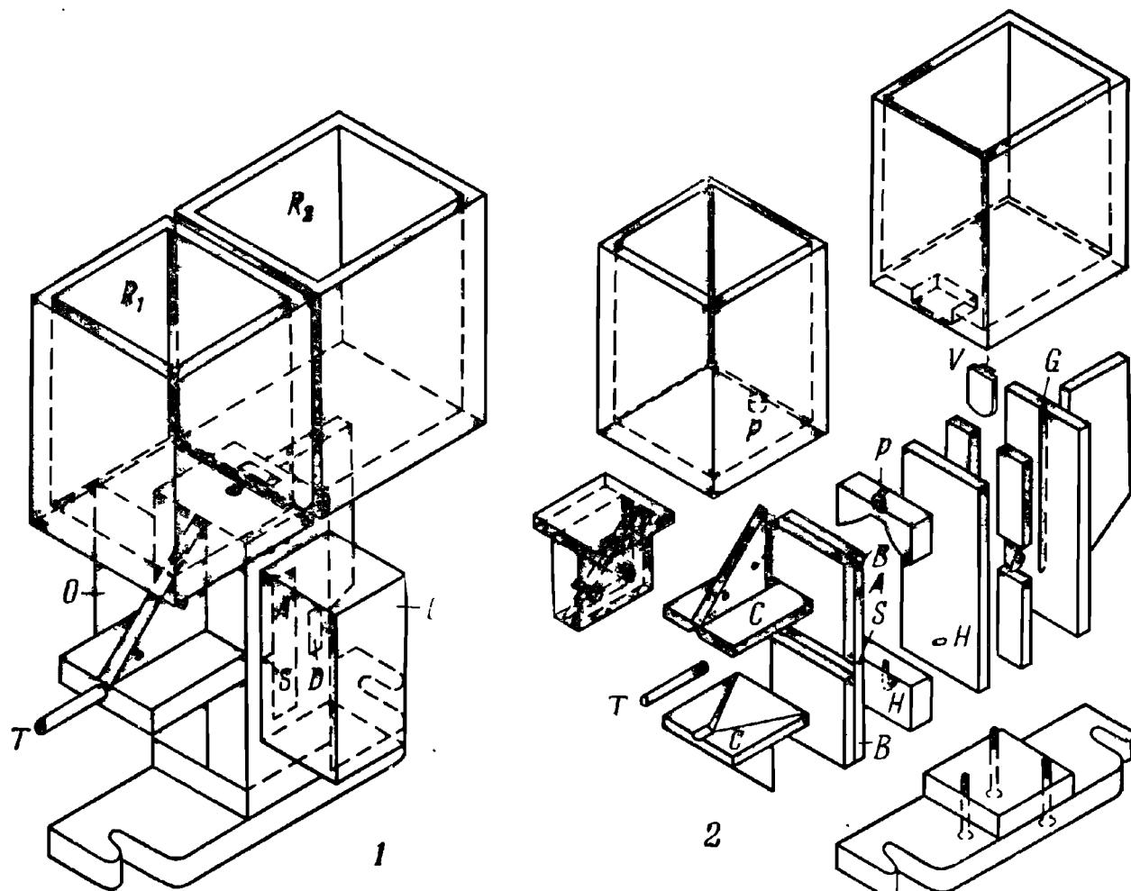
Рис. 10.10. Ячейка диффузиометра Гуи.
