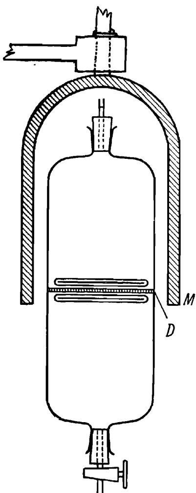
Рис. 10.1. Ячейка с диафрагмой и магнитной мешалкой (Стокс [5]).
