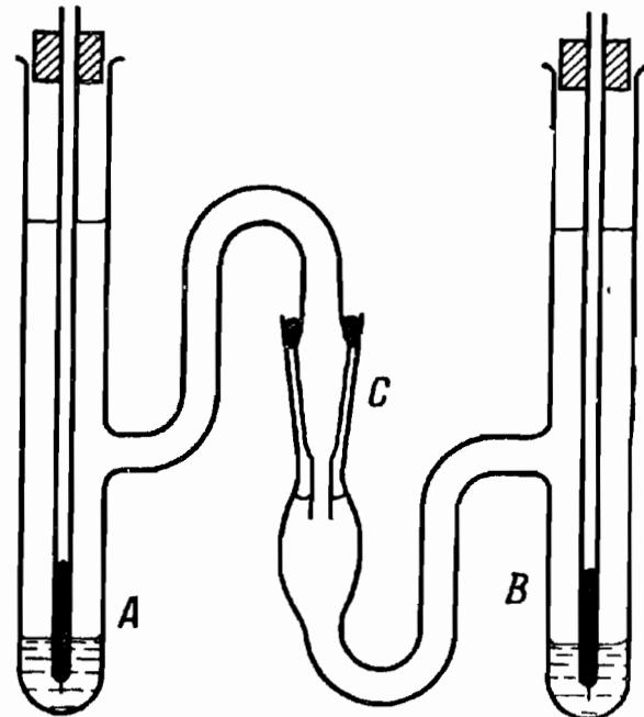
Рис. 5.14. Ячейка с переносом для определения чисел переноса в растворах перхлората цинка (Стокс и Левиен [33]).
