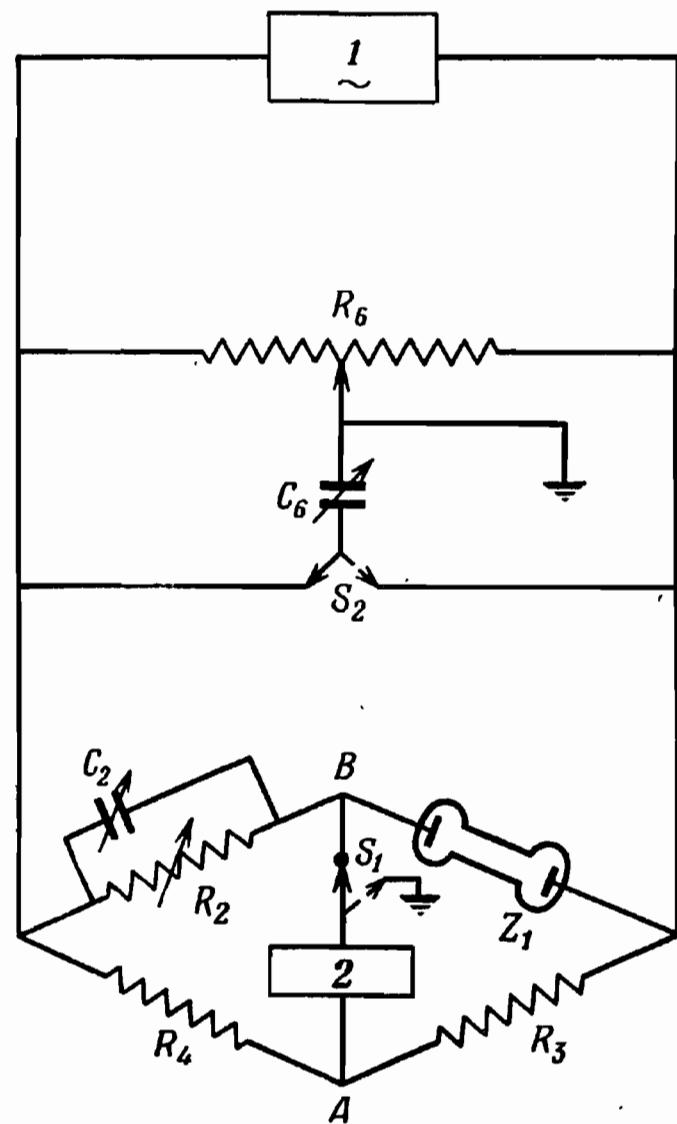
Рис. 5.2. Схема моста переменного тока для измерения электропроводности.
